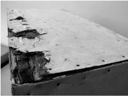
Przykładowe obrazy zniszczeń korpusów uli mających ściany z płyty pilśniowej twardej
