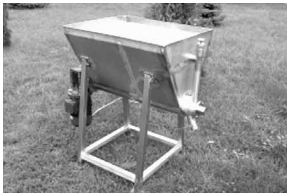
Fot. 1. Wygląd zewnętrzny urządzenia do uplastyczniania miodu skryształizowanego
