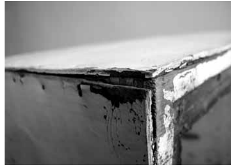
Przykładowe obrazy zniszczeń korpusów uli mających ściany z płyty pilśniowej twardej
